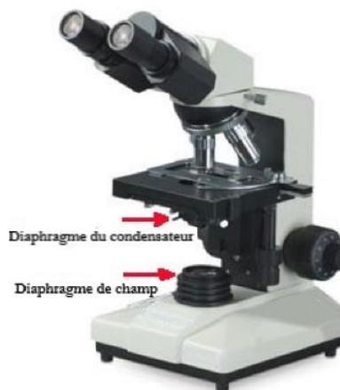
Note : Les termes *iris du condensateur* et *diaphragme d'ouverture* sont également utilisés pour désigner le diaphragme du condensateur.
