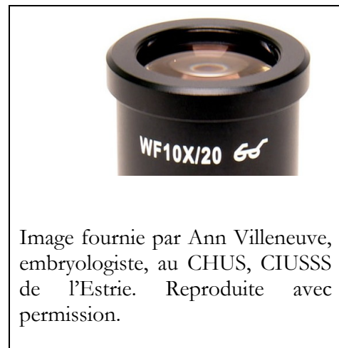
Figure 20. Oculaire dont le facteur de grossissement est de 10 x et le coefficient (ouverture) de champ est de 20 mm
